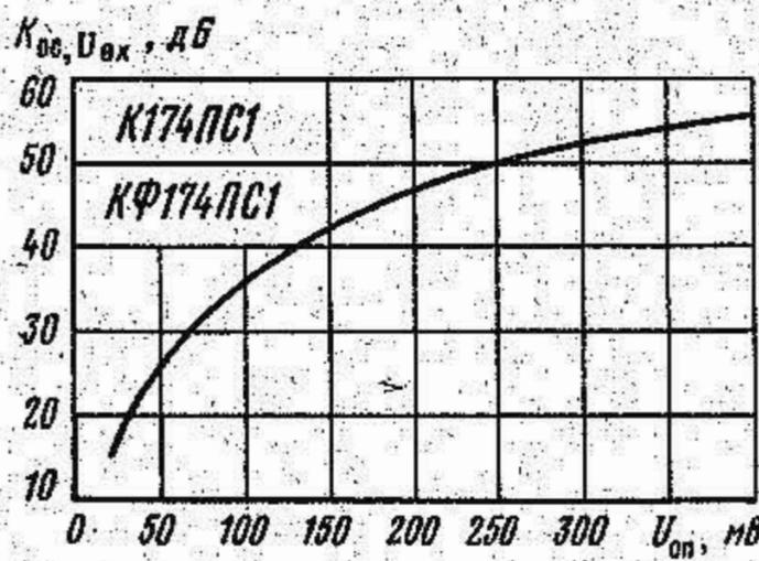
Зависимость коэффициента ослабления входного сигнала от величины опорного сигнала при  $U_n = 4...15 В$ ,  $T = +25^\circ С$
