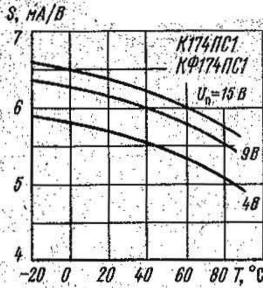
Зависимости крутизны преобразования от температуры окружающей среды при различных значениях напряжения питания
