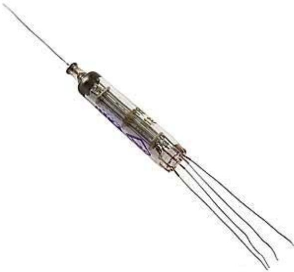
**1Ж18Б** - сверхминиатюрный высокочастотный пентод. Предназначен для усиления напряжения высокой частоты до 60МГц в аппаратуре батарейного питания. Может быть использован как усилитель промежуточной частоты, гетеродин или предварительный усилитель низкой частоты. 1Ж18Б - радиолампа стержневой конструкции, имеет катод прямого накала.
